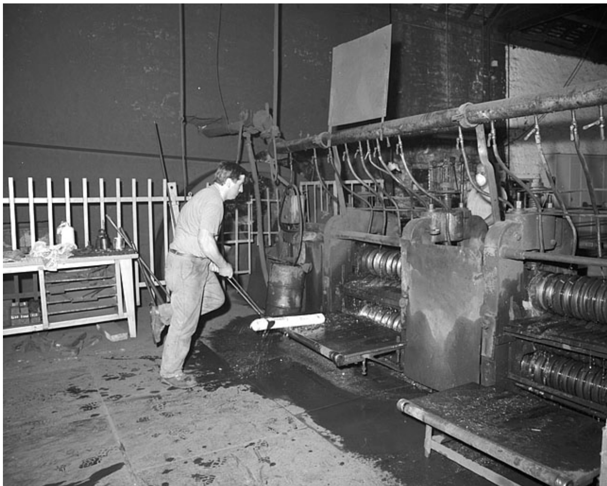
Laminoir : introduction de la billette en cage de dégrossis.
