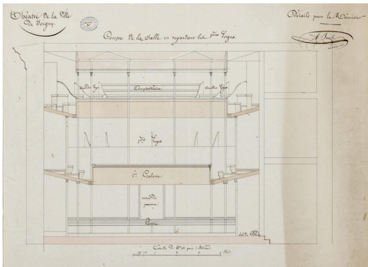
Construction de la salle de spectacle. Coupe de la salle en regardant les 1<sup>ères</sup> loges. Détails pour le menuisier. 1832.
