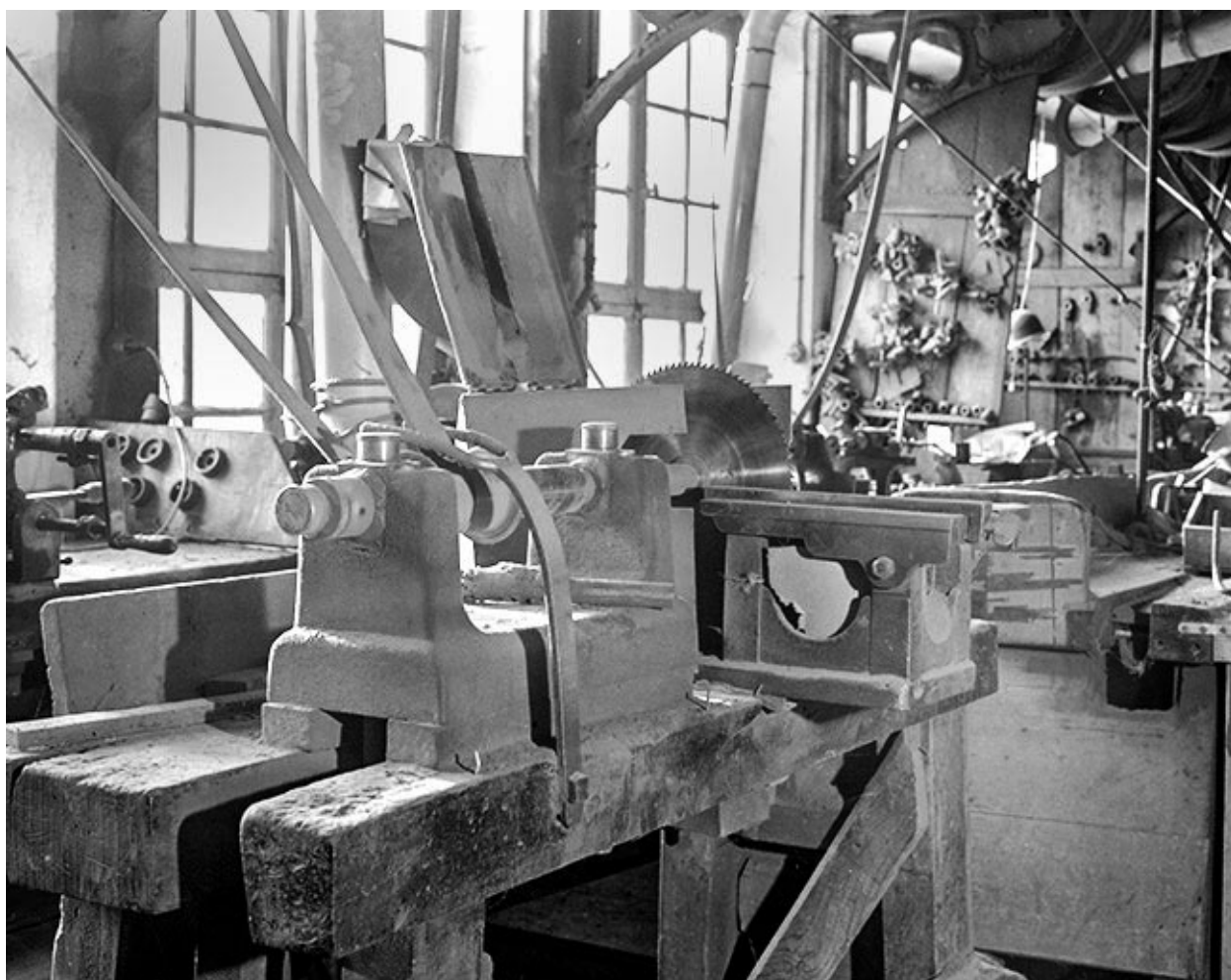
Atelier d'ébauchage : scie circulaire.
