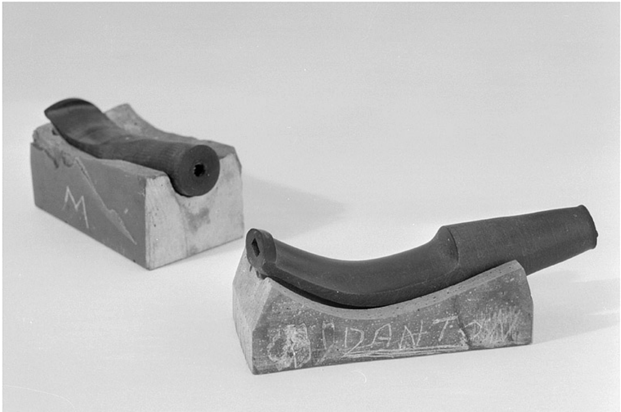
Détail de deux tuyaux en ébonite moulés dans leur marbres.
