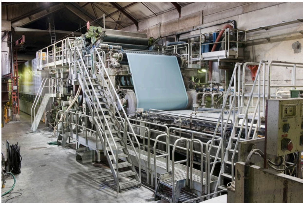
Usine de pâte à papier Paravicini-Maillard, actuellement Papeterie de Mandeuve, Mandeuve : table de fabrication et tête de la machine à papier.
