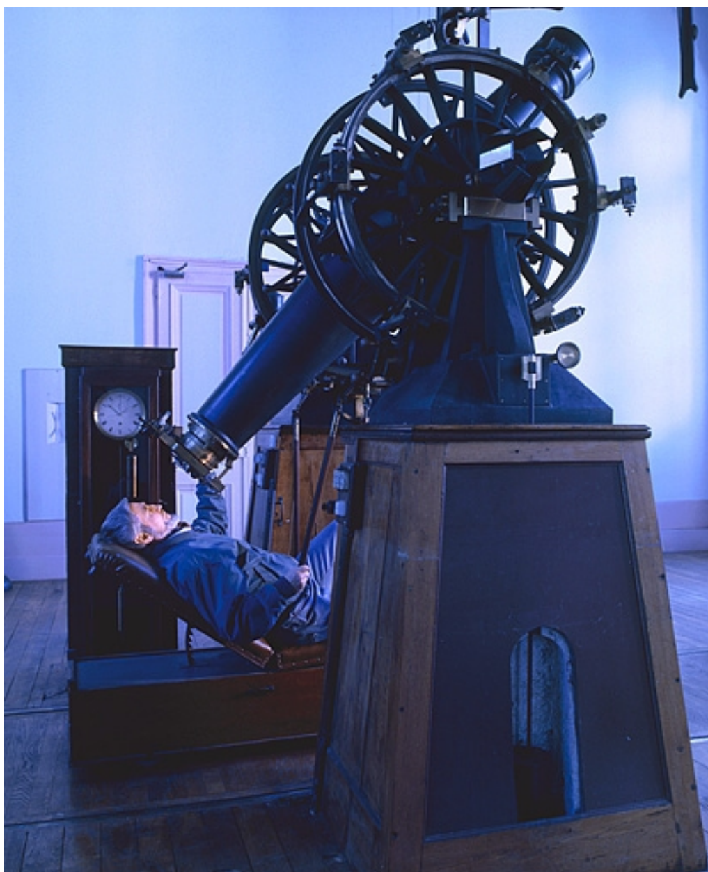
Observation avec le micromètre depuis le siège d'astronome.
