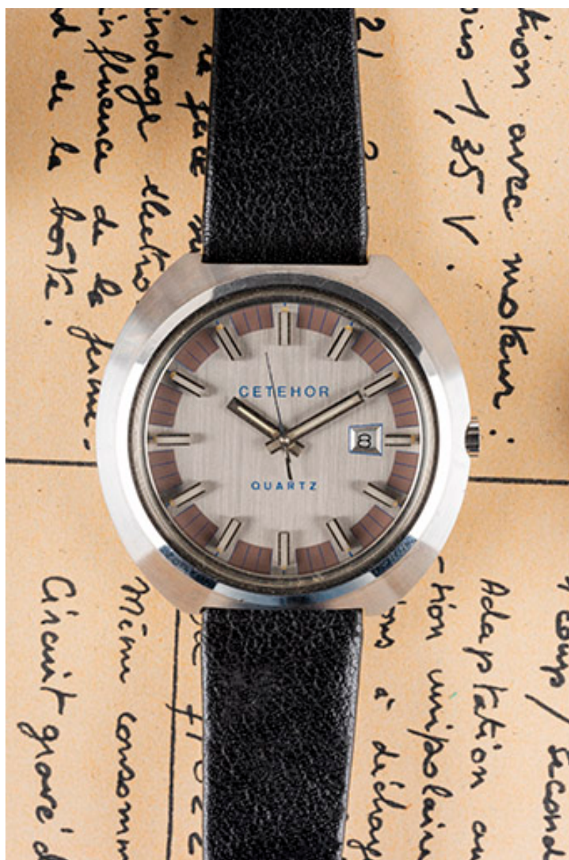
Prototypé n° 2 de montre à quartz du Cetehor (février 1972).
