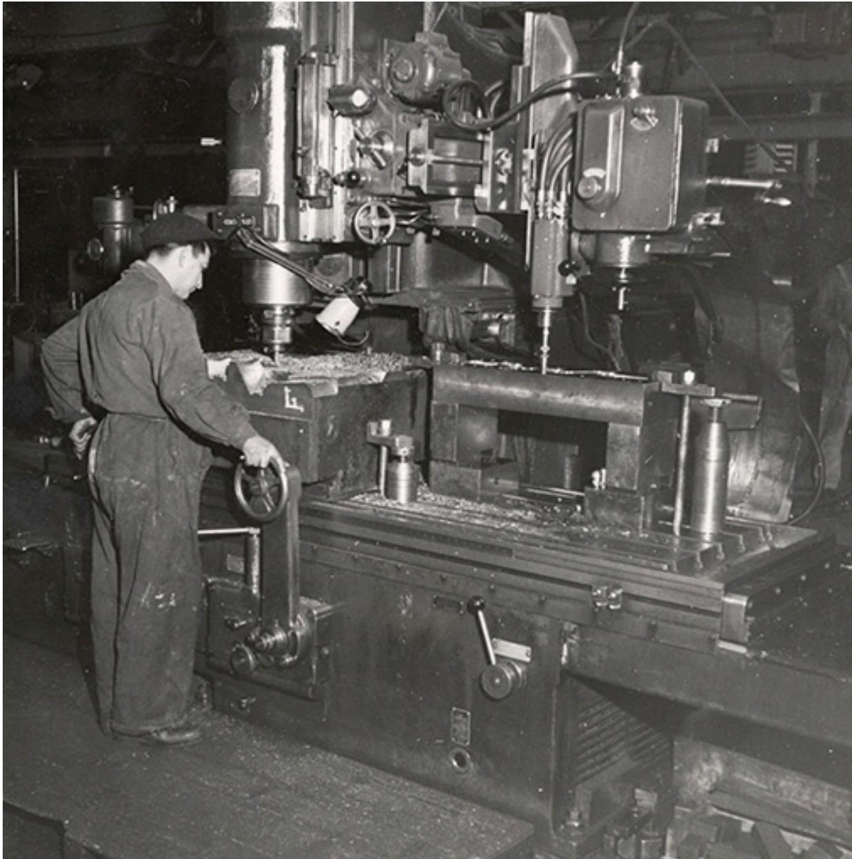
Fraisage pour usinage des matrices de forge.
