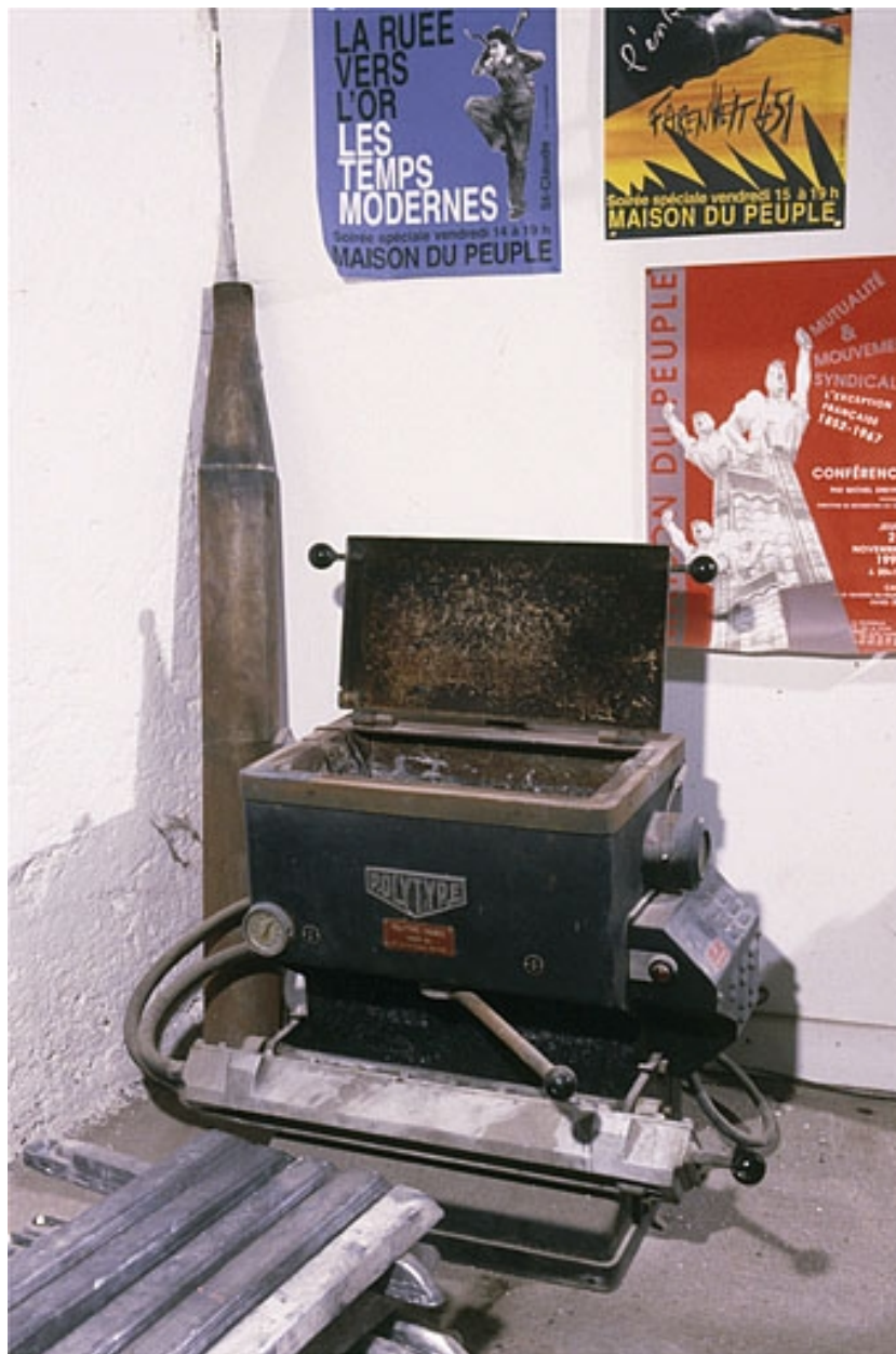
Machine à fondre (four électrique Polytype) : vue d'ensemble, couvercle ouvert.
