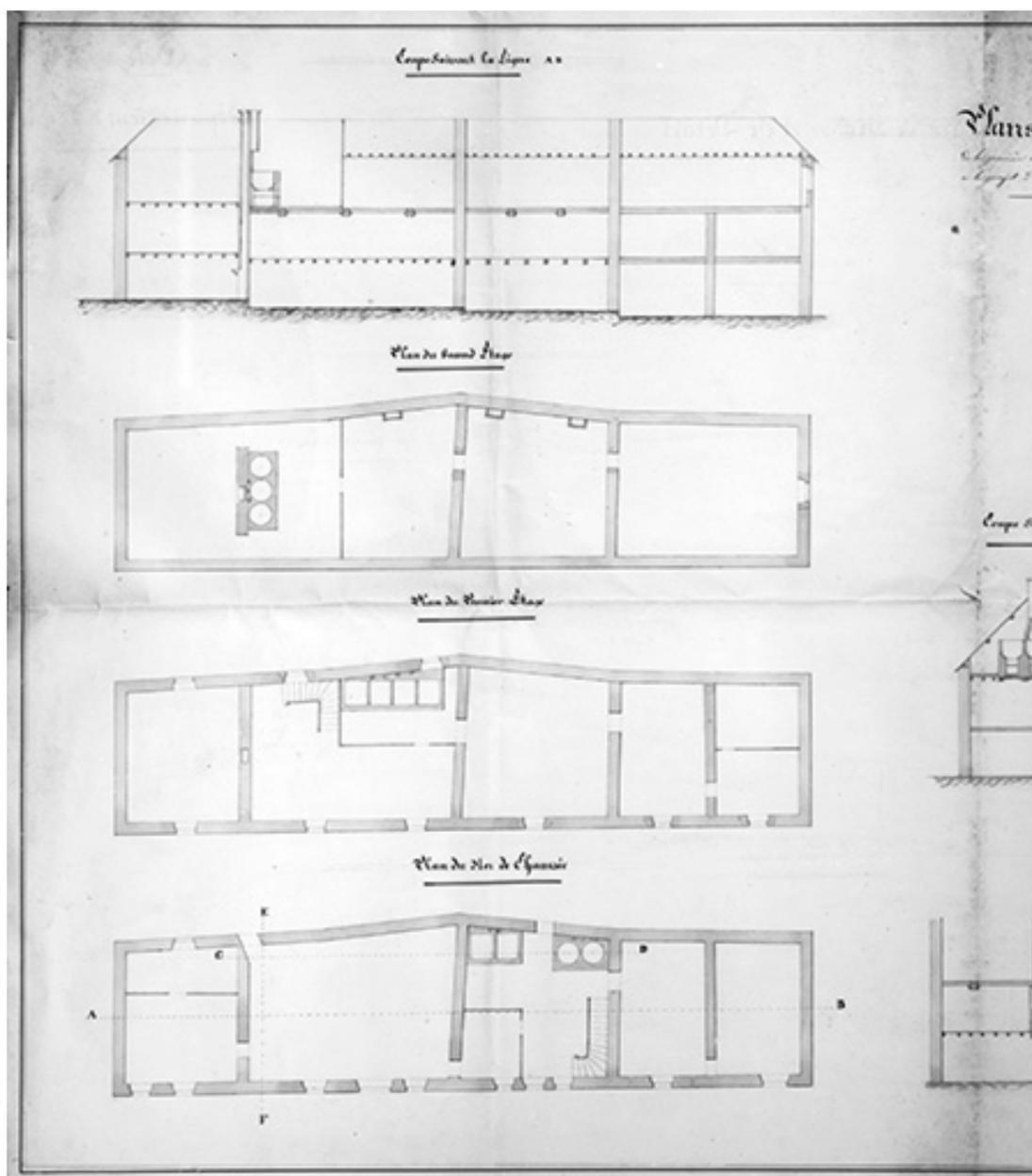
Plans de masse et de détail d'un bâtiment [...] dans lequel le sieur Révillon [...] a le projet d'établir une fabrique de sucre de bettes-raves [coupe longitudinale et plan à chaque étage].
