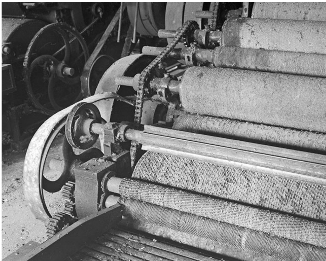
Détail du cylindre briseur. De gauche à droite, rouleaux alimentaires, cylindre briseur puis cylindres cardes de l'avant-train.
