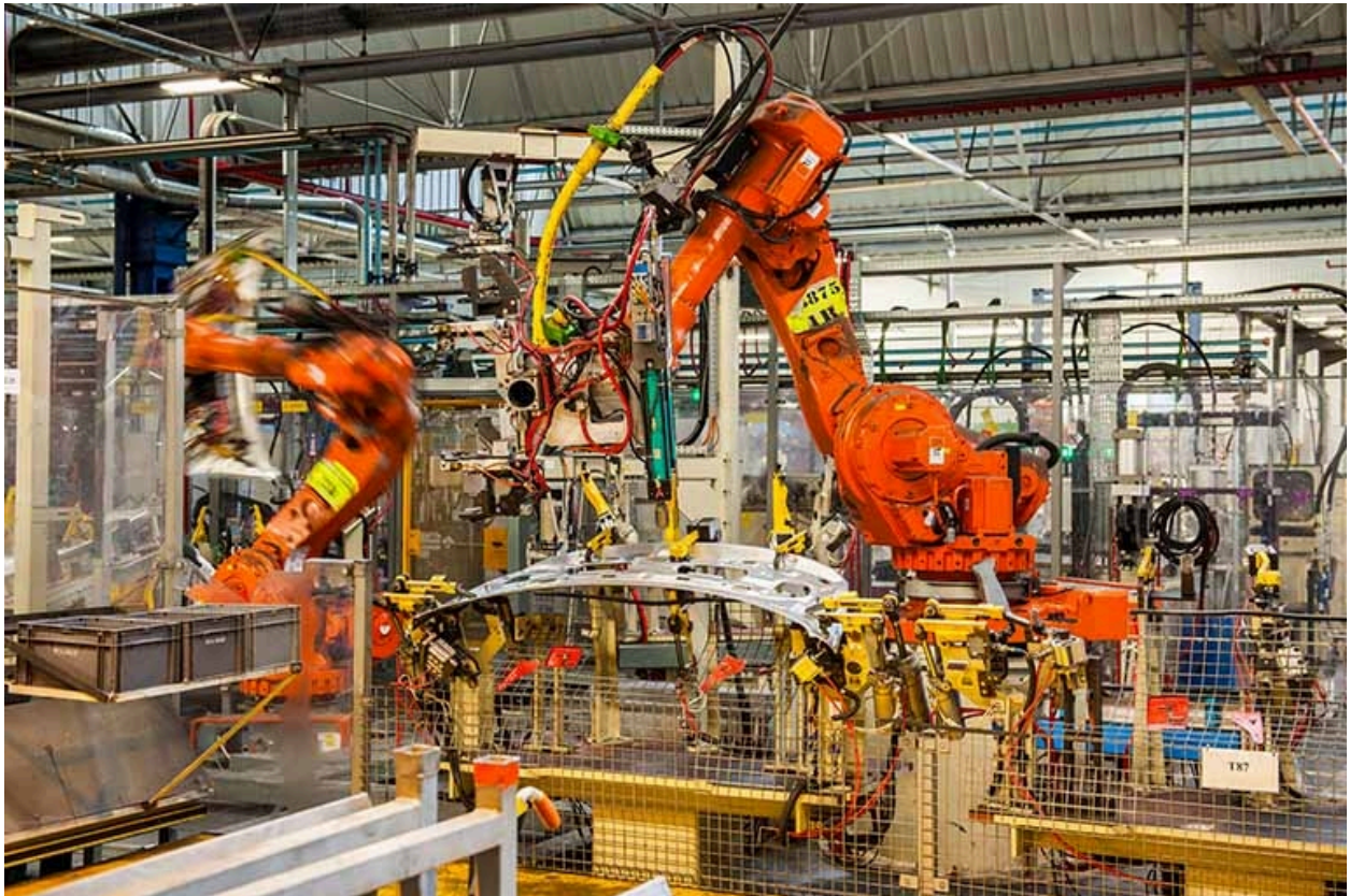
Atelier de ferrage. Entrée de pièces dans un îlot robotisé.
