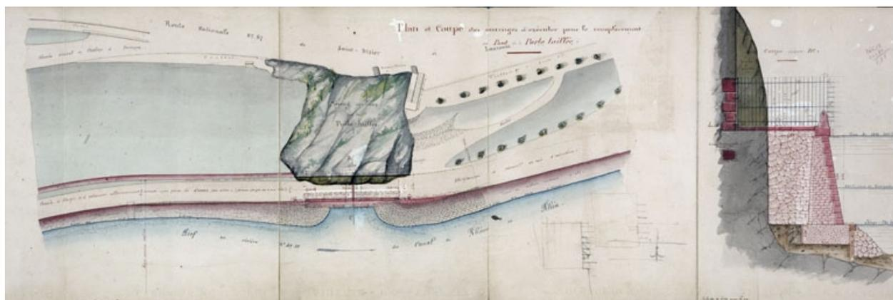
Besançon : remplacement du pont de la Porte taillée par un remblai perreyé. Dessins de détails du pont actuel et des ouvrages à y substituer [détail : ouvrages prévus], 1881.
