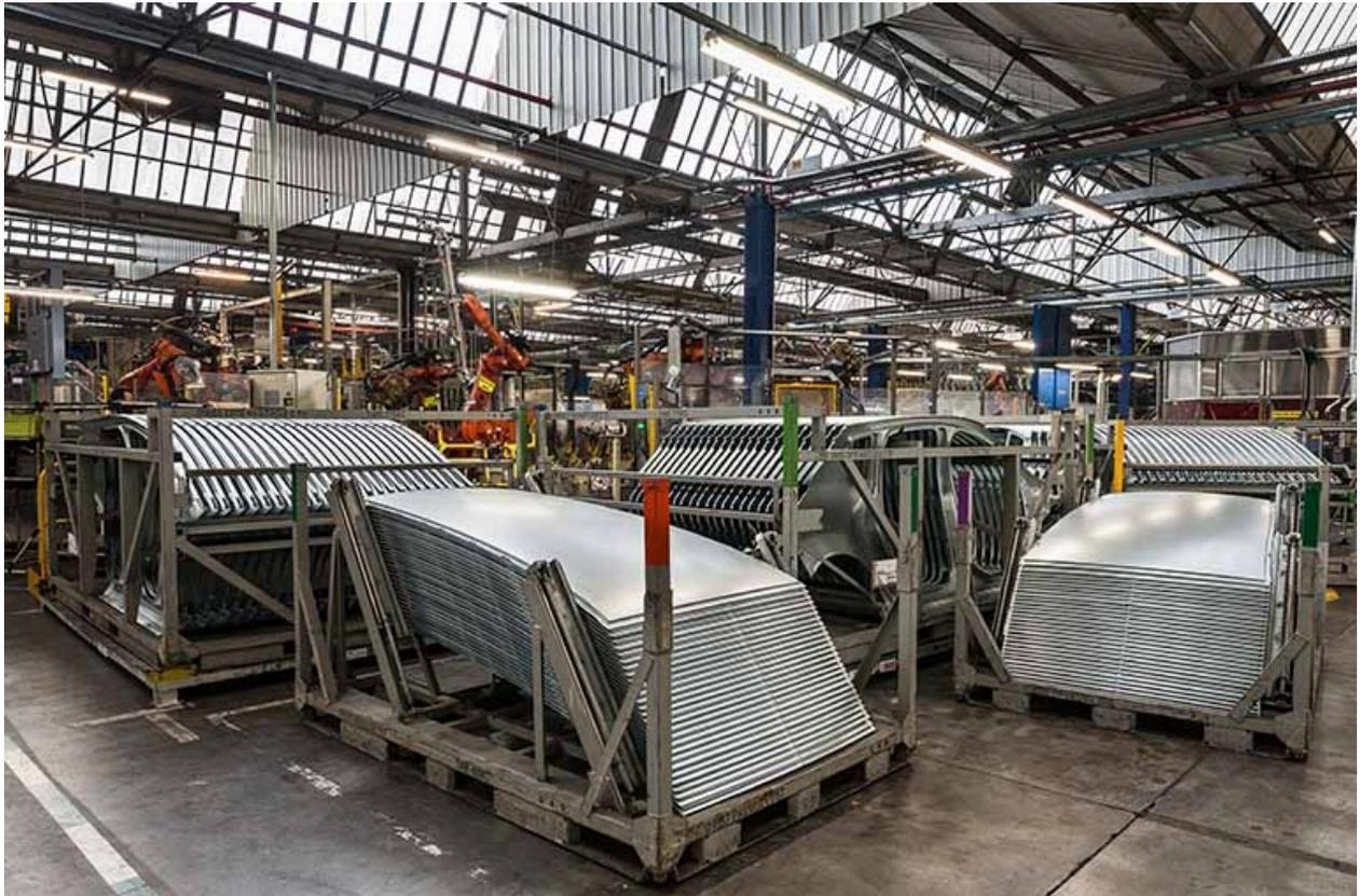
Atelier de ferrage. Stockage de pièces de caisses en blanc avant admission dans un îlot robotisé.
