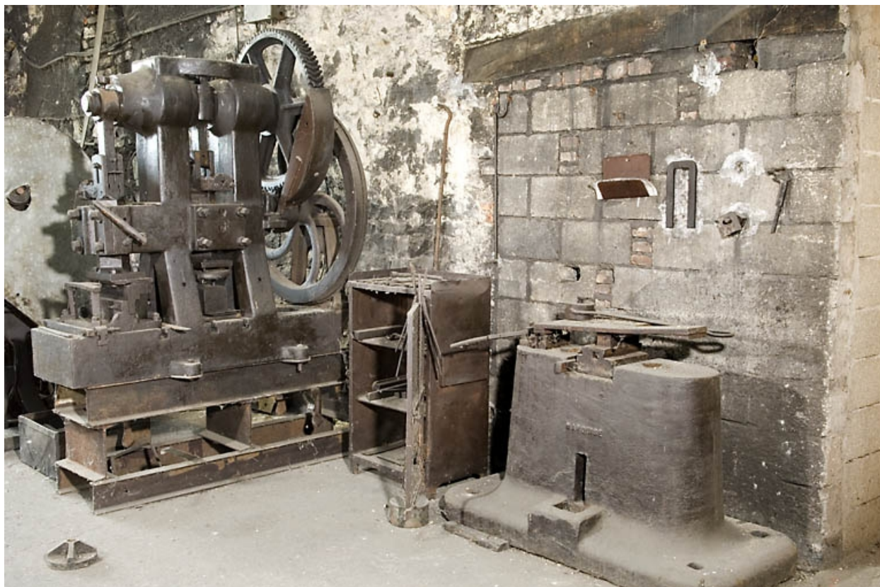
Atelier est. Découpoir et machine à couder Marquise (barres de fer).
