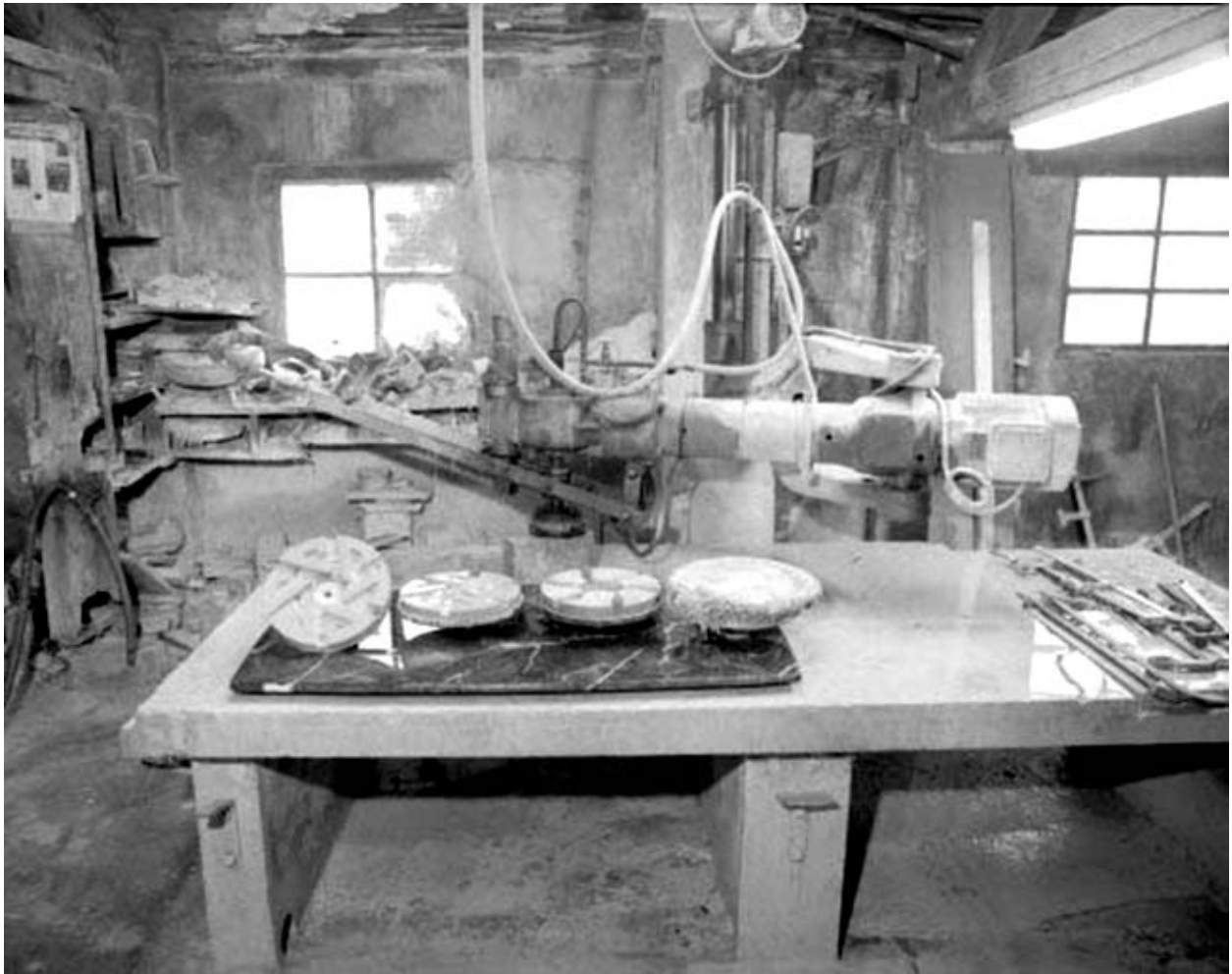
Polissoir à genouillère et ses plateaux. Plateaux à revêtement en carborandum, en acide oxalyque et en cordes.
