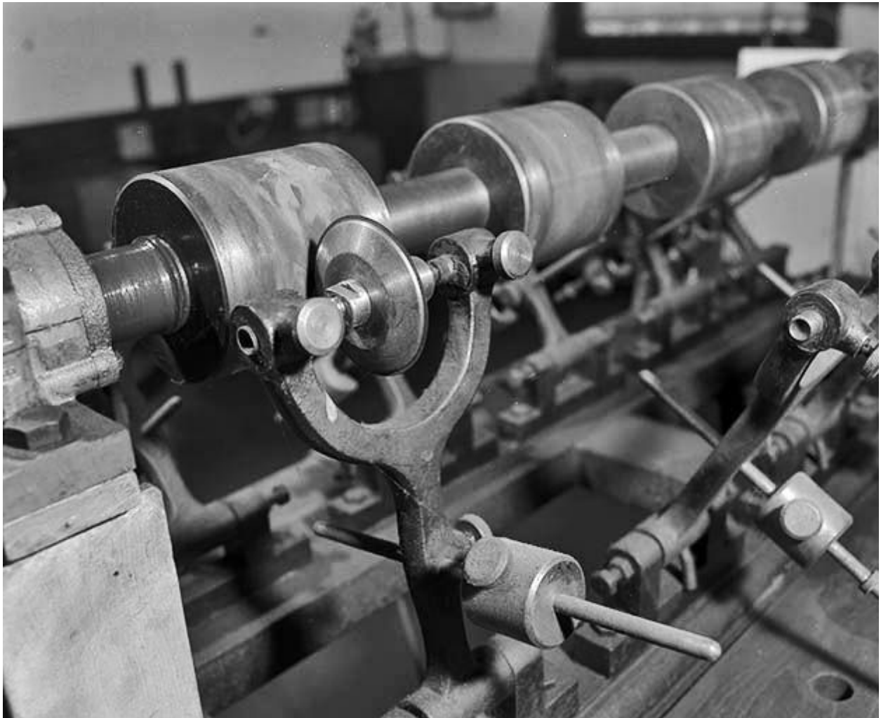
Emplacement de diamantage, avec molette en place.
