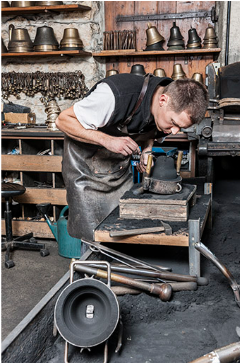
Moulage. Travail de finition à la spatule.
