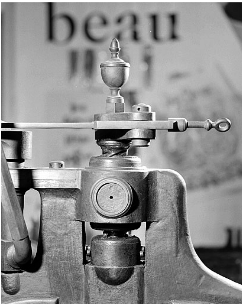
Partie supérieure de la vis, avec le système de transmission du mouvement du barreau.
