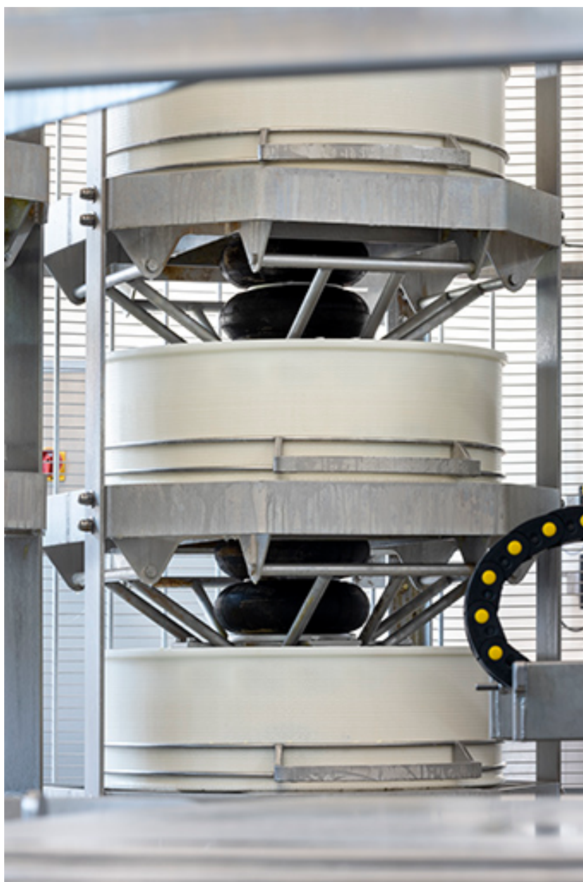
Installation de pressage : places avec moules.
