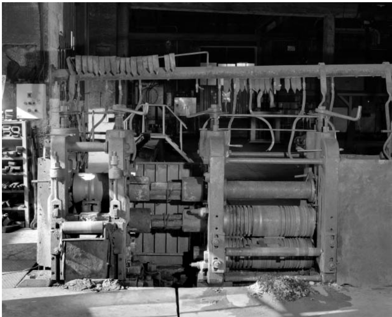
Cages du laminoir : finissage et refouloir.
