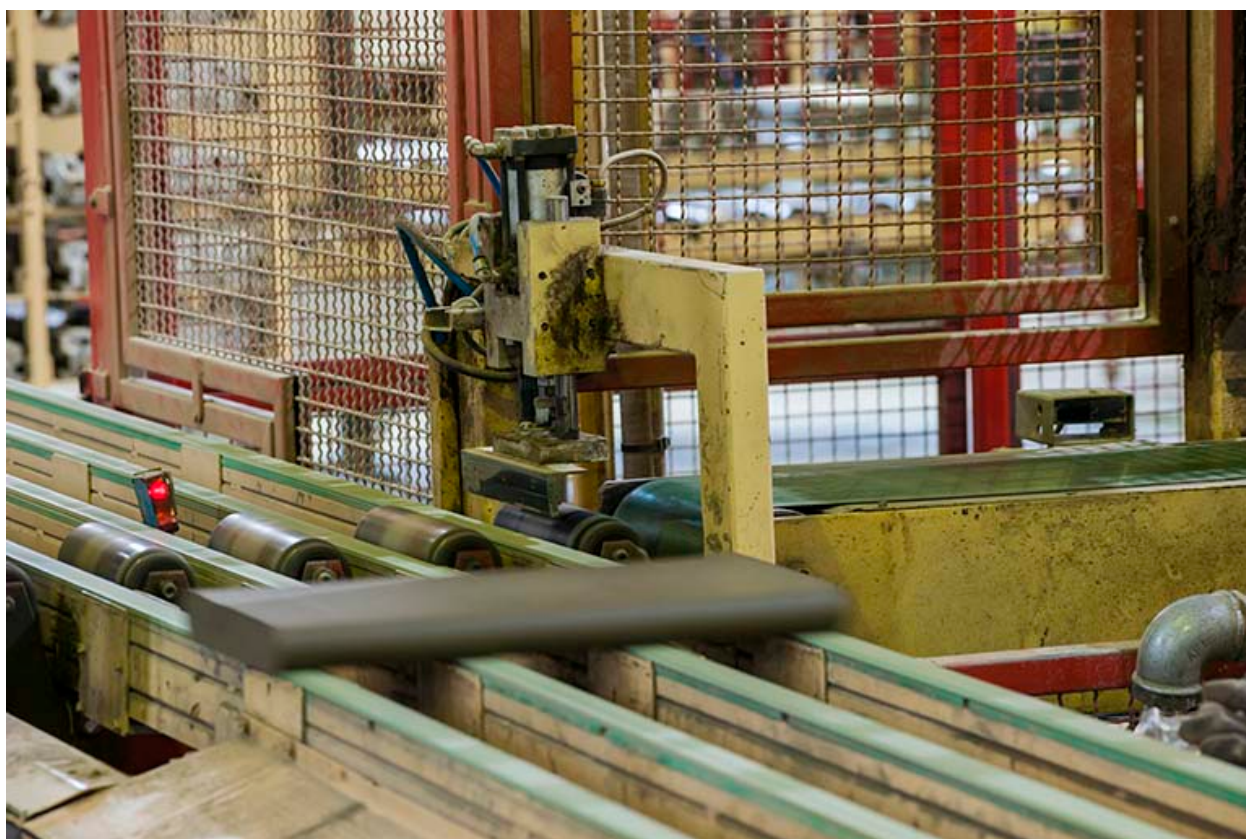
Unité de fabrication dite UL 3. Une "galette" après découpage par fil de la bande de terre.
