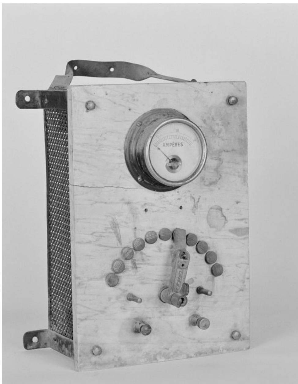
Accessoire d'éclairage, 1988 : rhéostat (transformateur).
