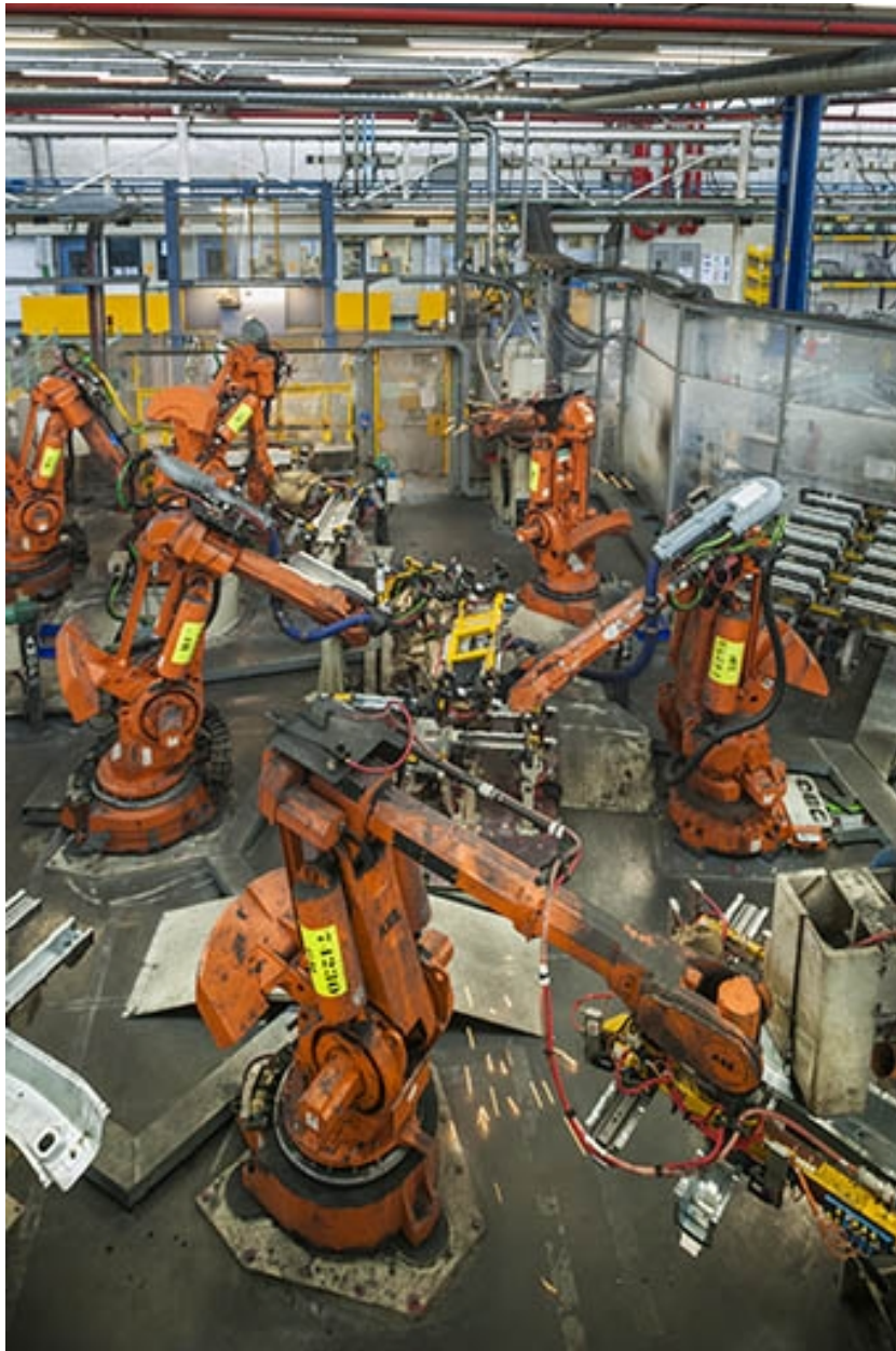
Atelier de ferrage. Soudage des pièces de la caisse en blanc dans un îlot robotisé (2).
