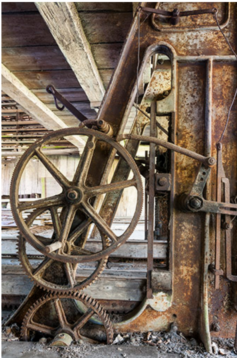
Détail du mécanisme d'entraînement du châssis.
