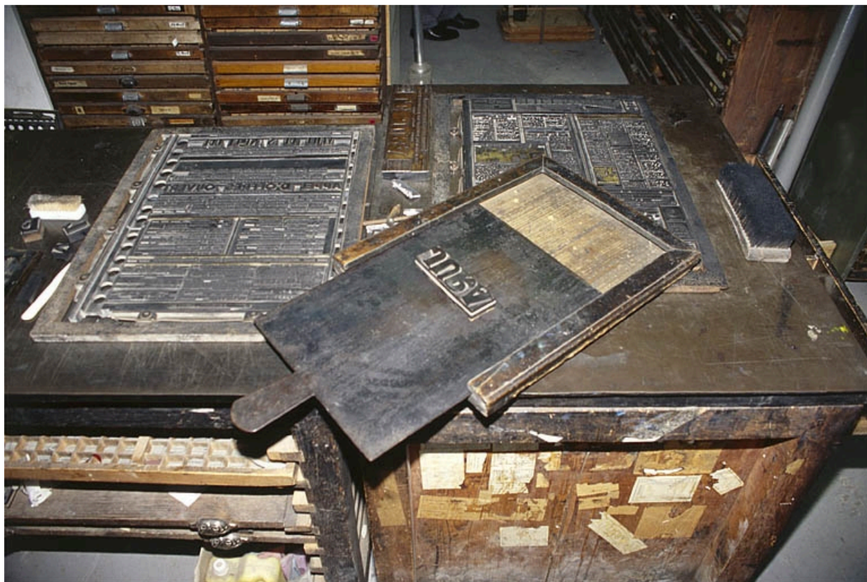
Galée en acier, posée sur un marbre.
