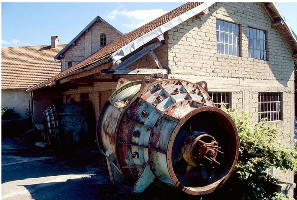
Turbines déposées devant le magasin industriel.
