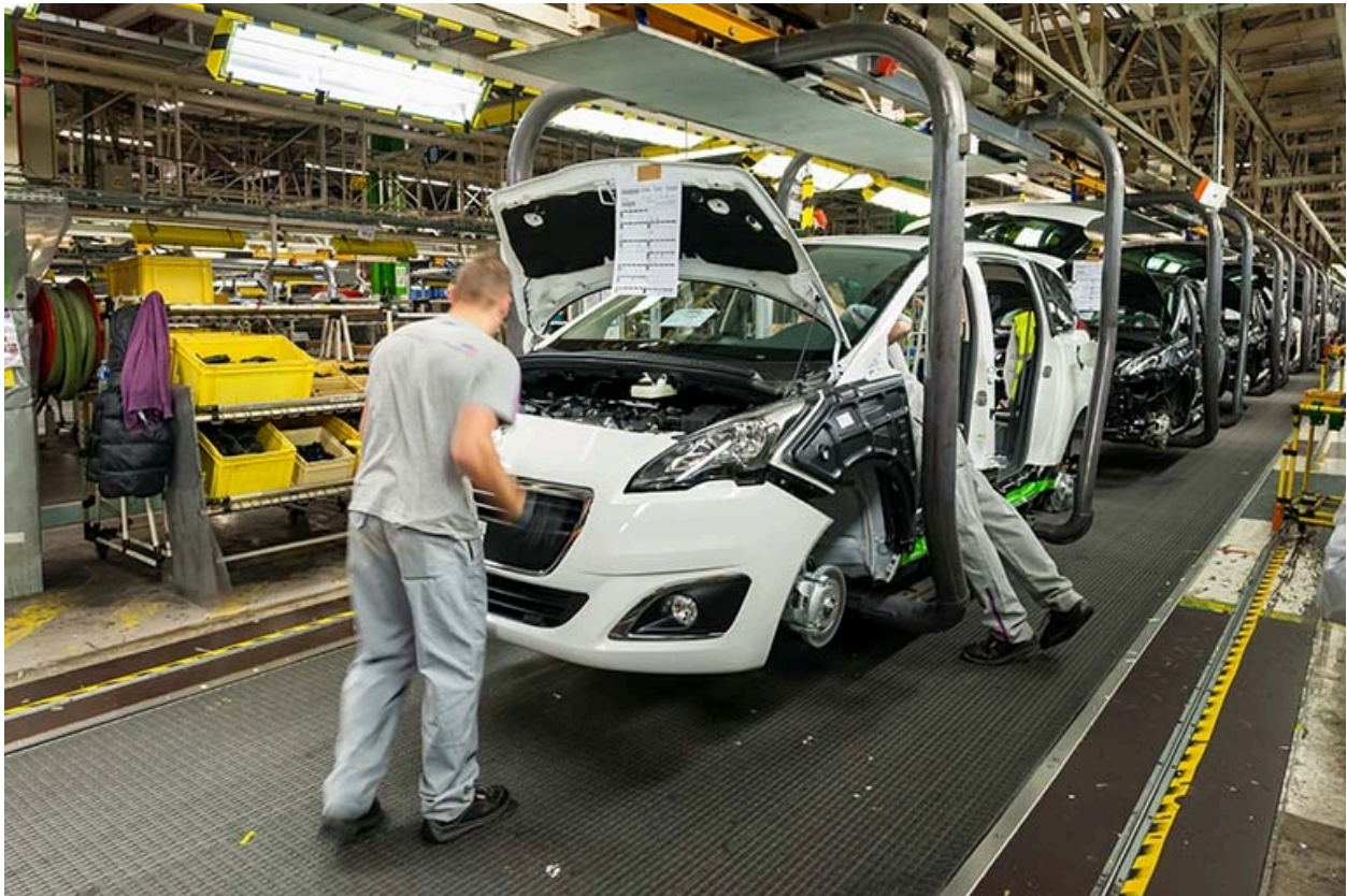
Atelier de montage. Pose du pare-choc.
