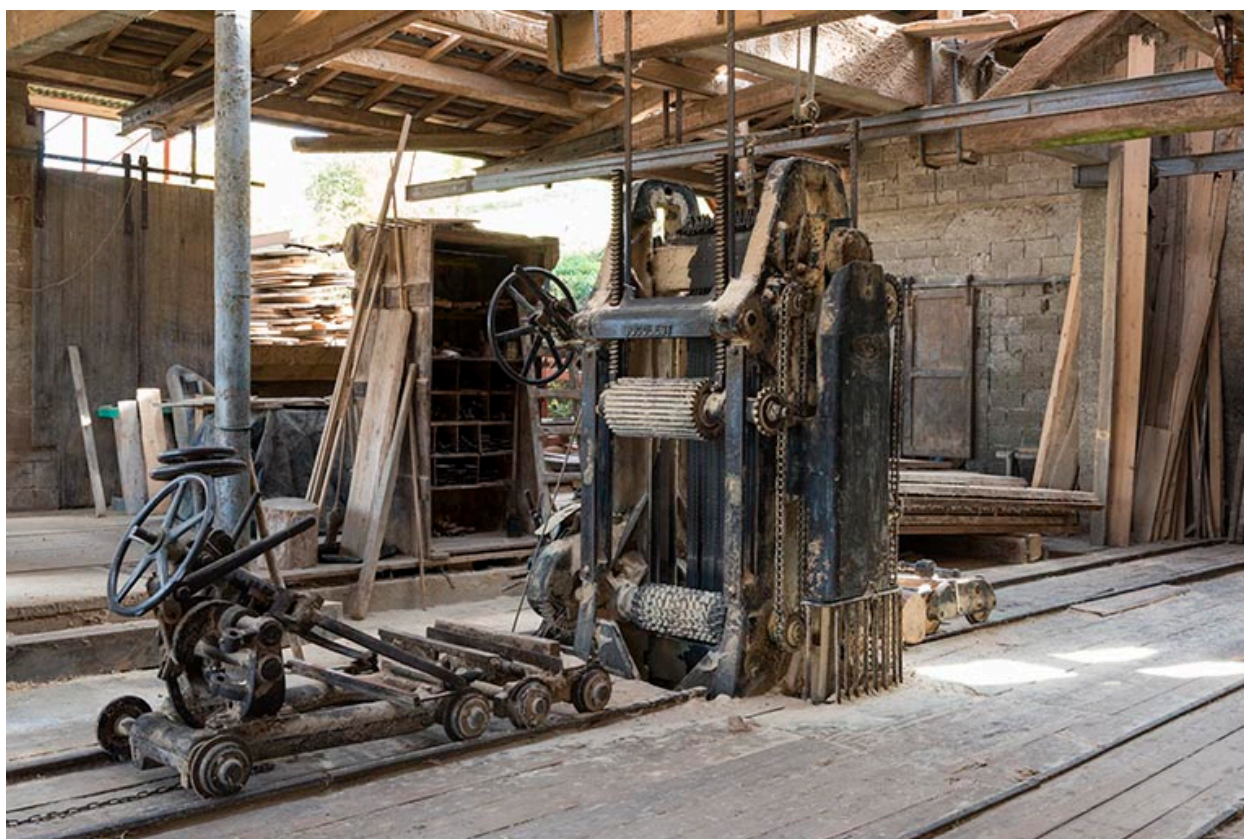
Scierie Vermot-Desroches puis Gaiffe, actuellement Faivre, Montlebon (Derrière le Mont) : châssis de scie multilame Socolest.
