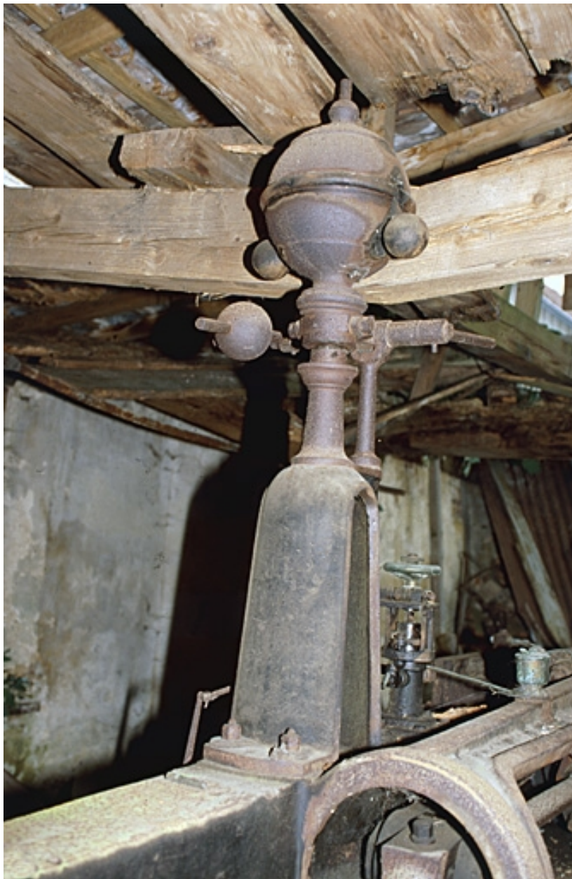
Machine à vapeur : détail du régulateur à boules. L'entrait de la charpente, brisé, repose sur le régulateur.
