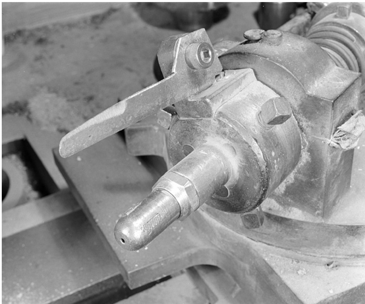
Détail du système de fixation du fourneau par l'intérieur du foyer (arrondisseur de l'atelier de finissage).
