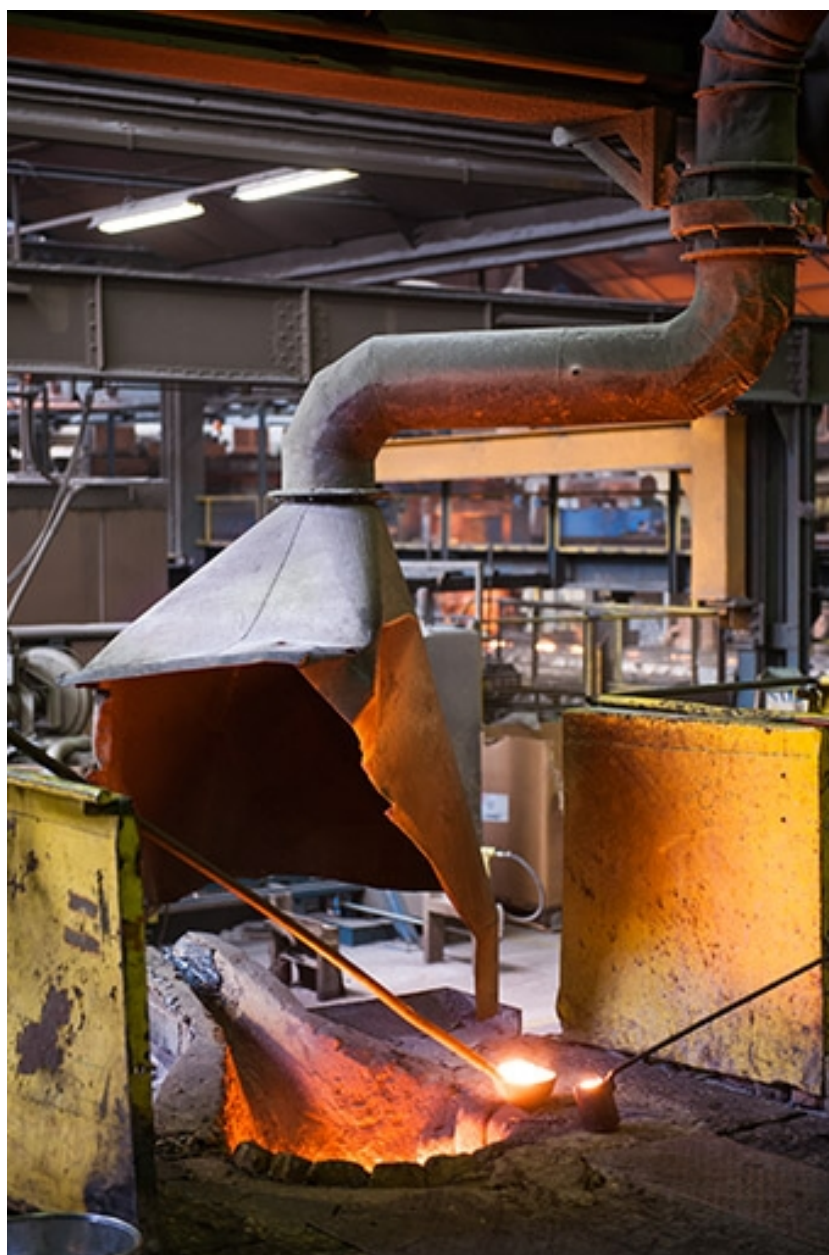
Prélèvement de matière en fusion dans un four à induction (3).
