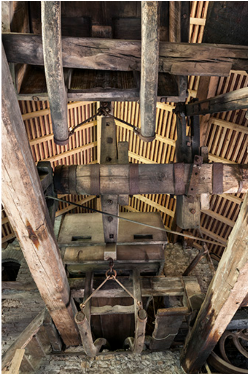
Mécanisme de bascule du soufflet double (caisson sud en position basse).
