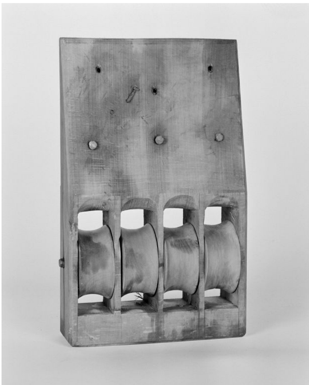
Accessoire des cintres, 1988 : poulie quadruple.
