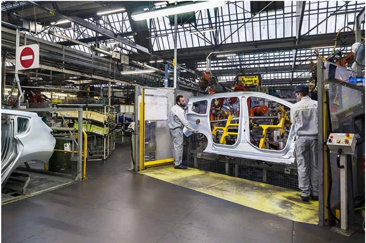
Atelier de ferrage. Entrée d'un côté de caisse de 5008 dans un îlot robotisé.
