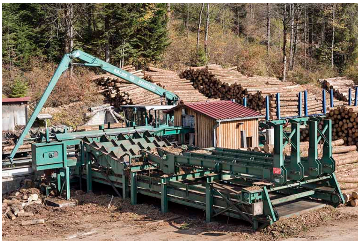
Chariot de tronçonnage Baljer Zembrod et écorceuse.
