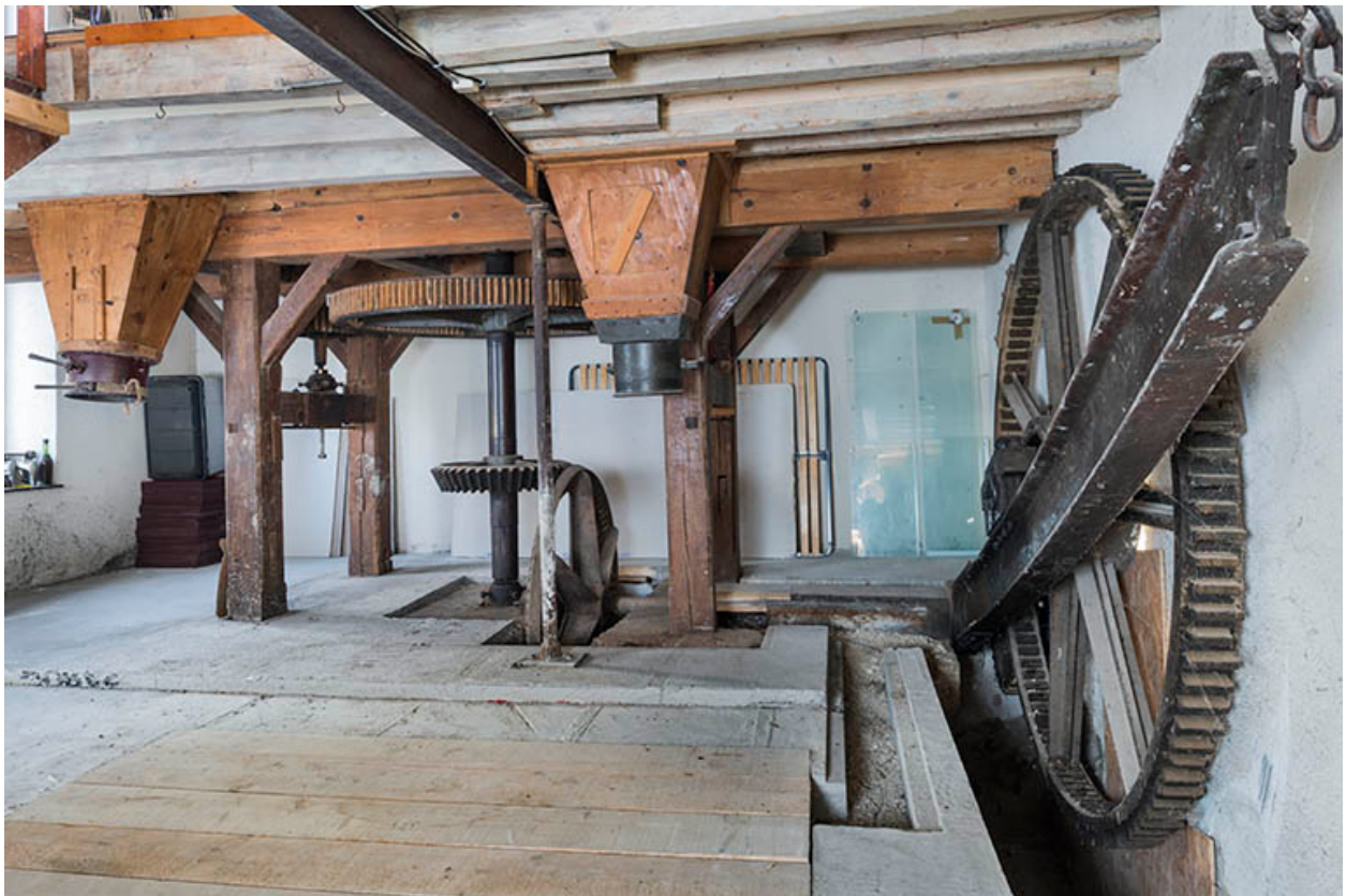
Partie sud du rez-de-chaussée : beffroi des meules et mécanisme de levage de la roue (amont).
