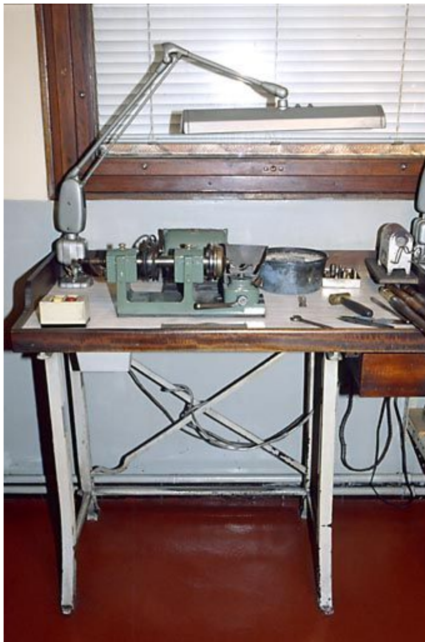
Vue d'ensemble d'une machine à débruter et de son four à résistance.
