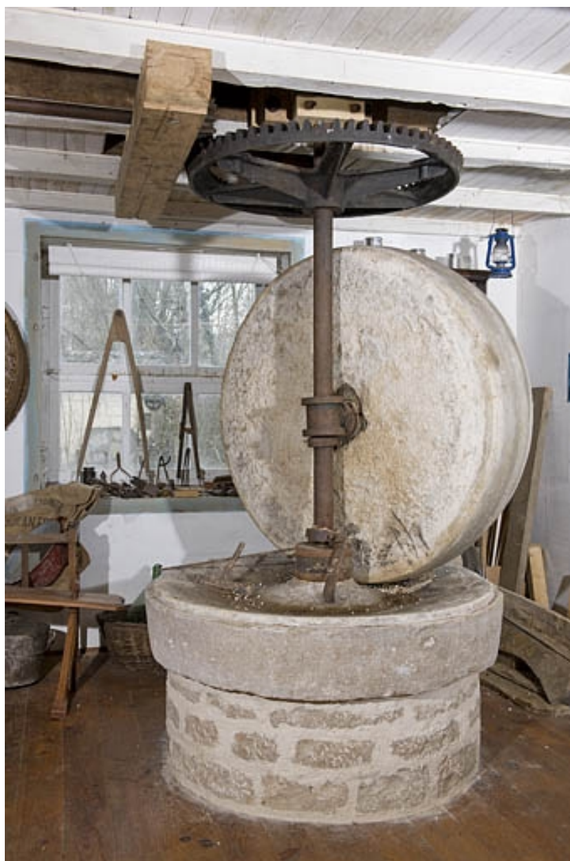
Meules de broyage installées dans le logis.
