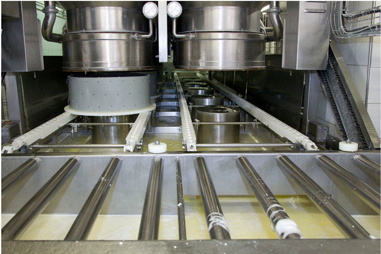
Fabrication du comté : installation de soutirage (cloches et moule).
