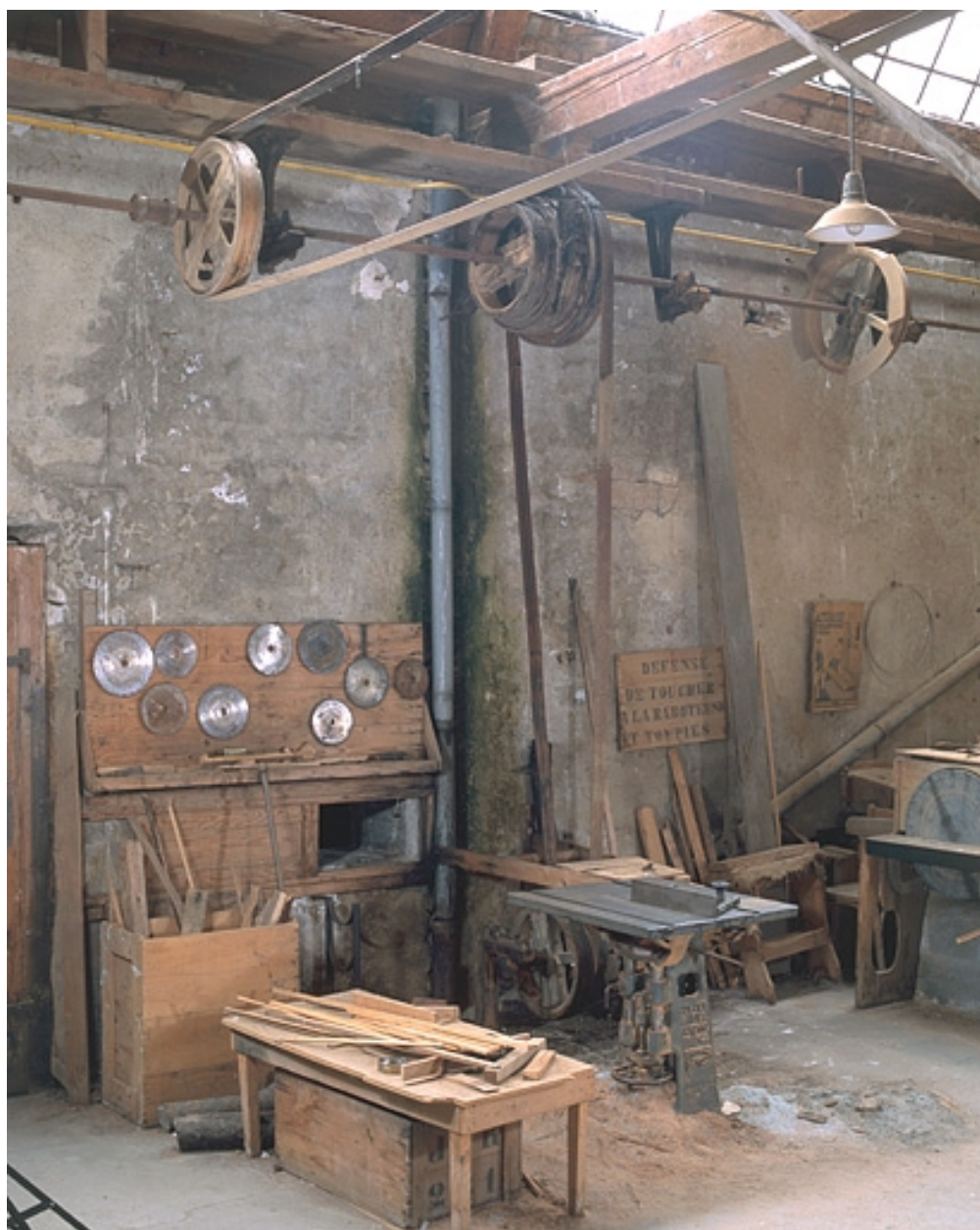
Vue d'ensemble avec le système de transmission.
