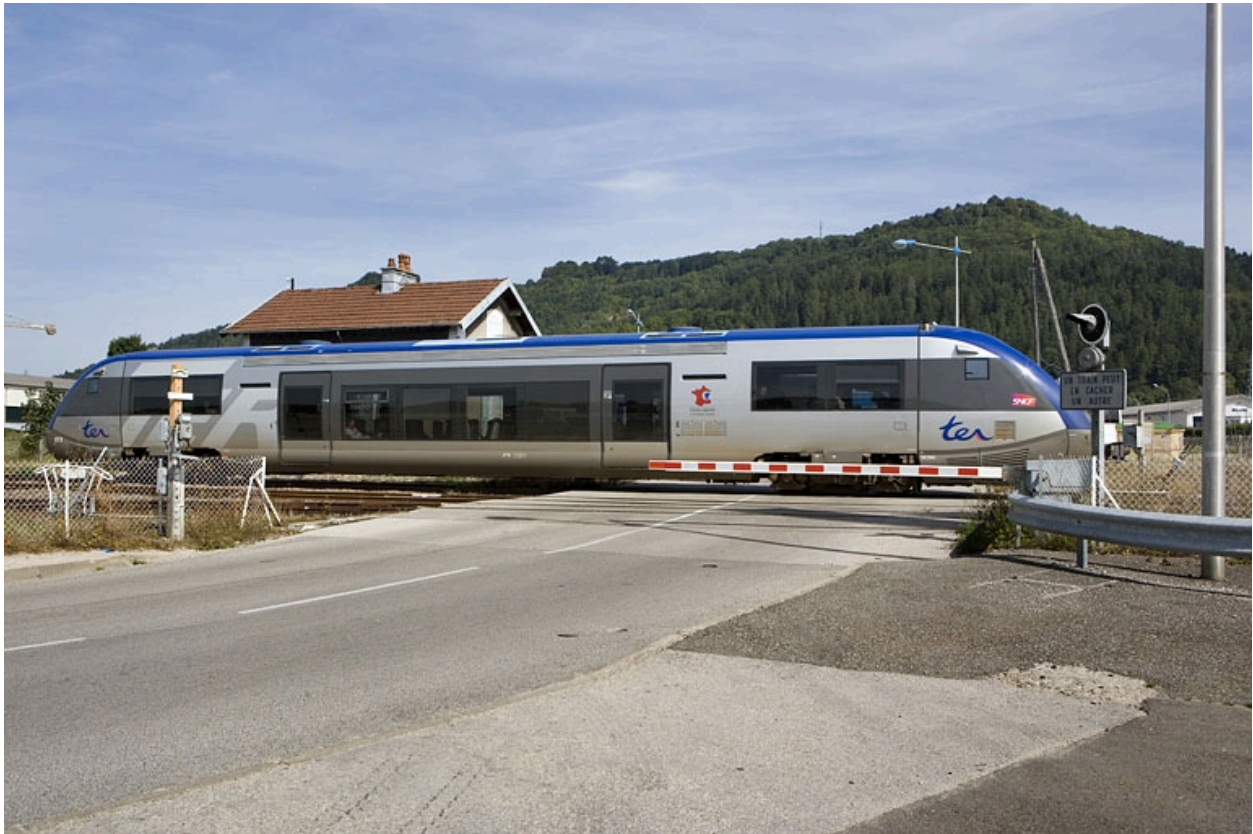
Vue d'ensemble de la barrière côté ville, baissée au passage d'un autorail X 73500.
