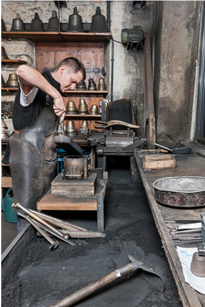
Moulage. Remplissage du châssis.
