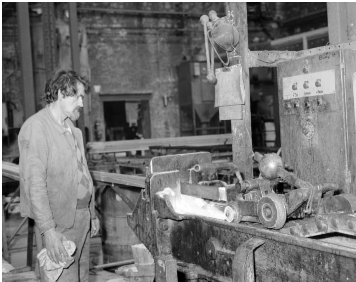
Atelier d'étirage : étirage d'une barre d'acier.
