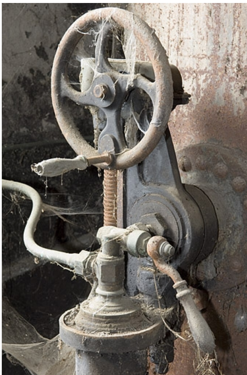
Atelier de distillation. Alambic Egrot et Grangé. Volant du mécanisme de bascule.
