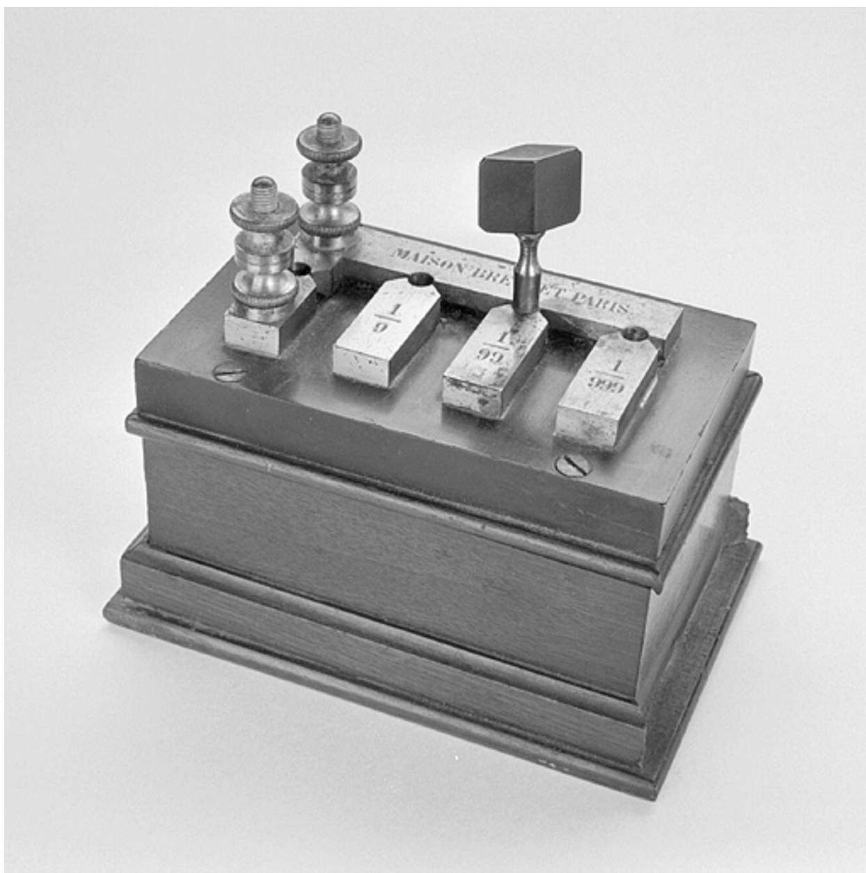
Shunt : vue d'ensemble.
