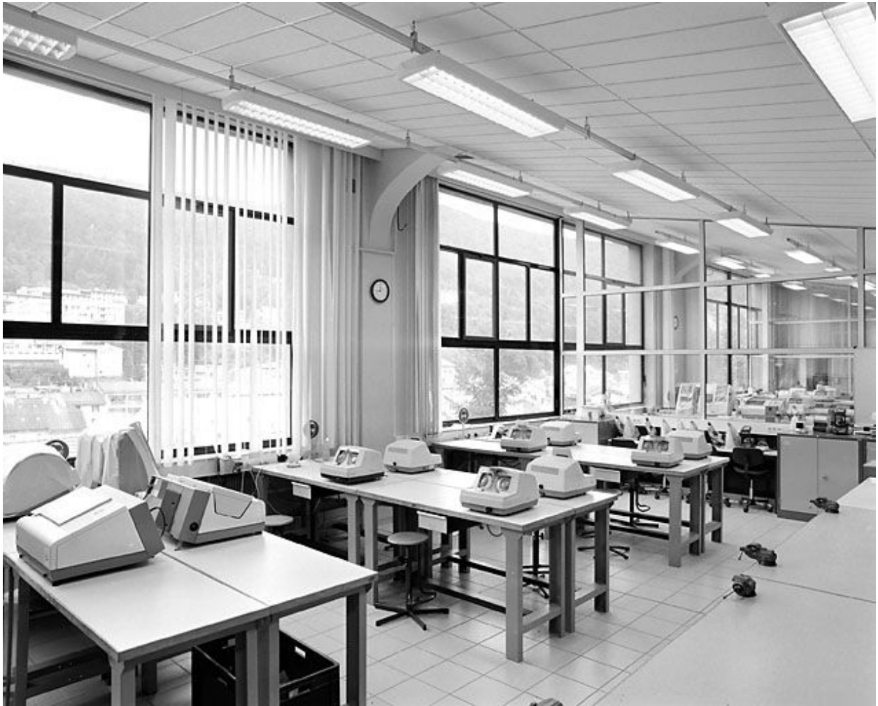
Bâtiment B, optique-lunetterie (1er étage) : machines à déborder.
