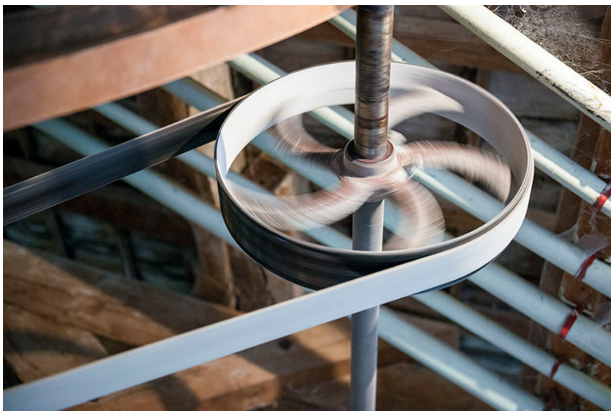
Troisième étage. Poulie et courroie du plansichter.
