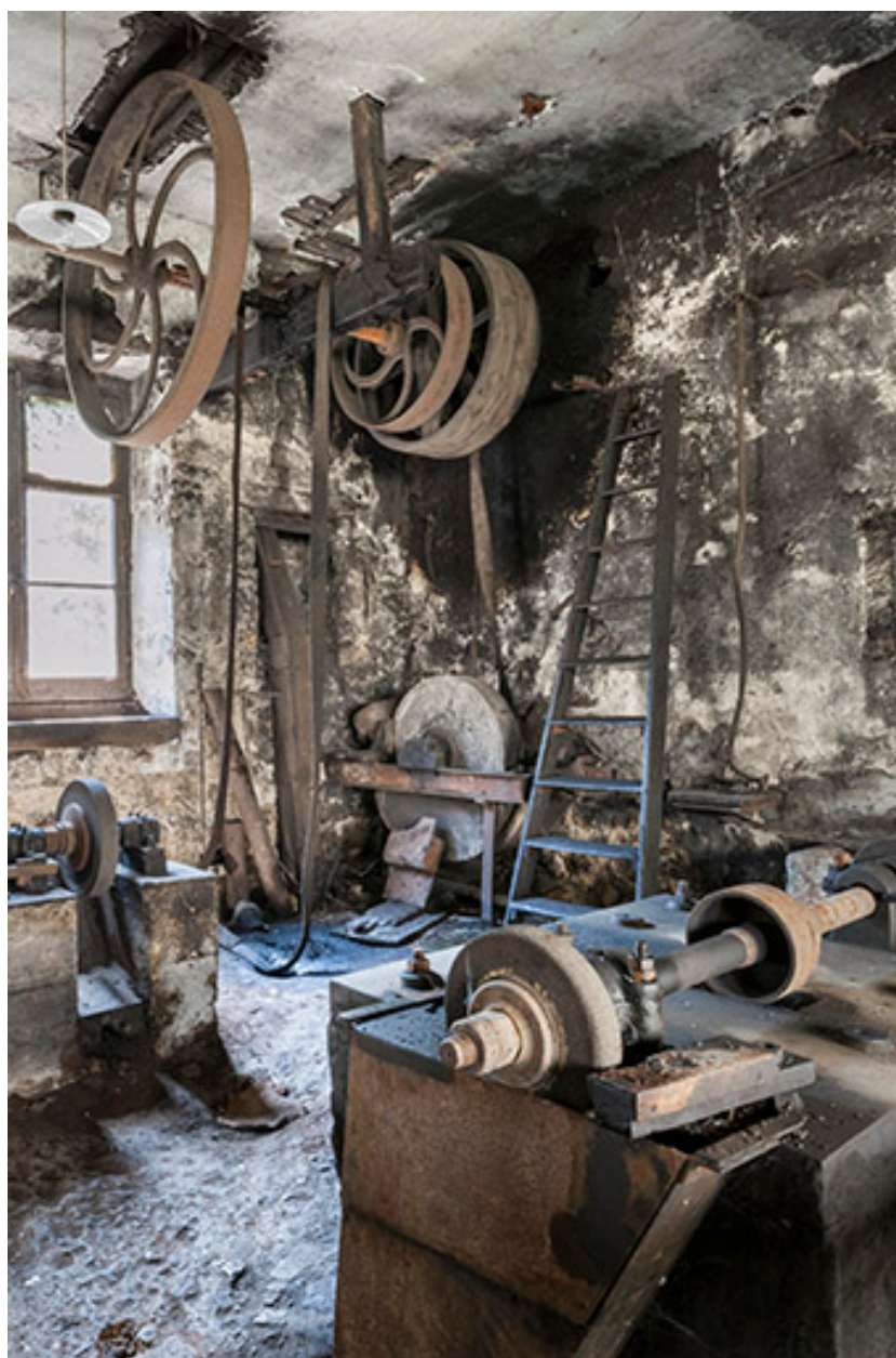
Atelier de mécanique. Transmission aérienne et polissoirs.
