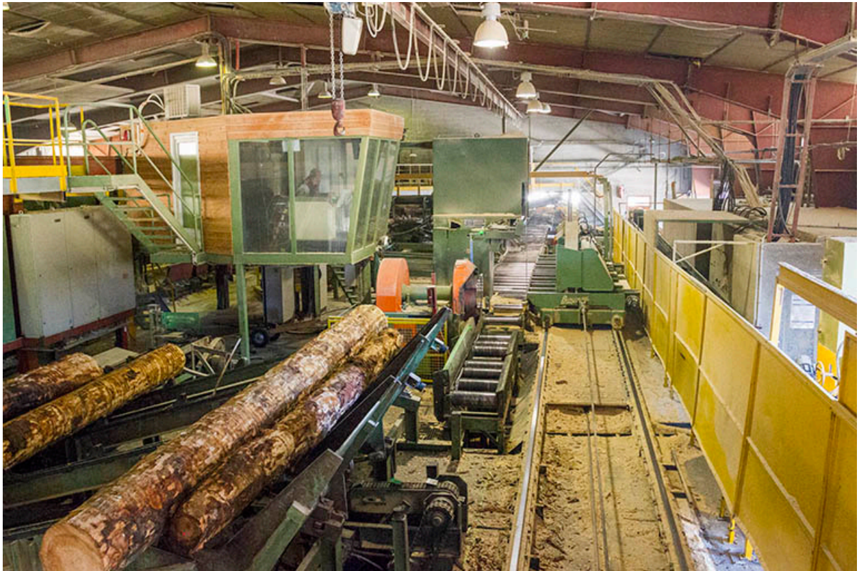
Scierie Thidric puis Gaume ou Grande Scierie mécanique de Maïche, Maïche : ligne ruban, pour les commandes diversifiées.
